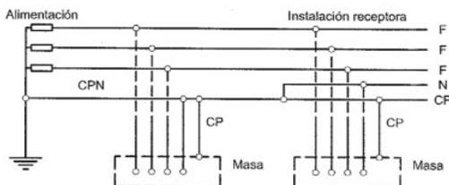
En los esquemas TN cualquier intensidad de defecto franco fase-masa es una intensidad de cortocircuito. El bucle de defecto está constituido exclusivamente por elementos conductores metálicos.
