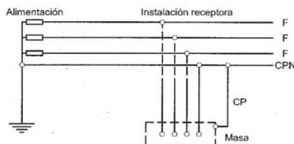
Esquema TN-C-S: En el que las funciones de neutro y protección están combinadas en un solo conductor en una parte del esquema (figura 3).
