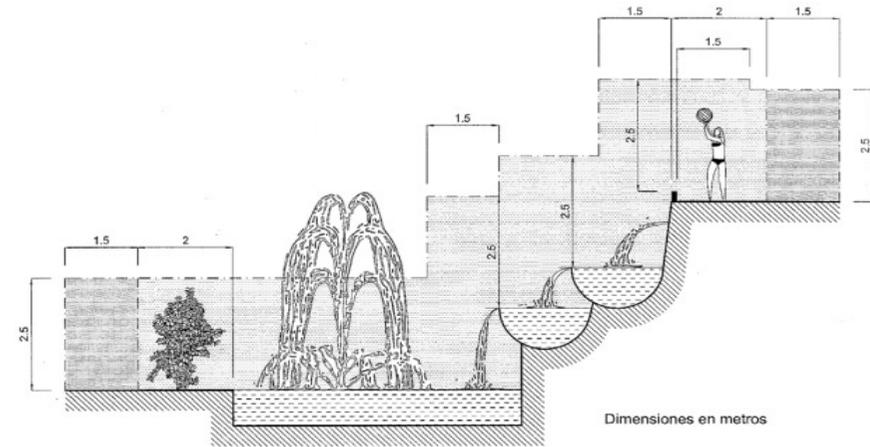
Figura 4. Volúmenes de protección en piscinas con paredes
