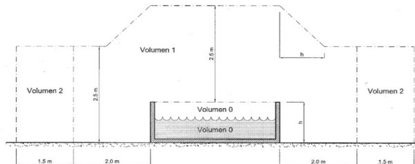
Figura 3. Dimensiones de protección en piscinas con paredes de altura mínima 2,5 m.
